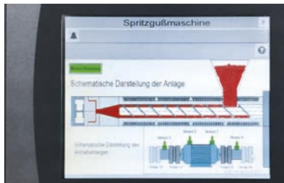
Panel des Onlinesystems an der CM-Box. Hier können Daten einzelner Sensoren eingesehen werden
