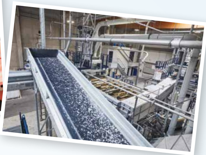
W wielostopniowym procesie przetwarzania następuje jednorodne materiałowo oddzielenie poszczególnych tworzyw sztucznych pochodzących z pociętych urządzeń chłodniczych
