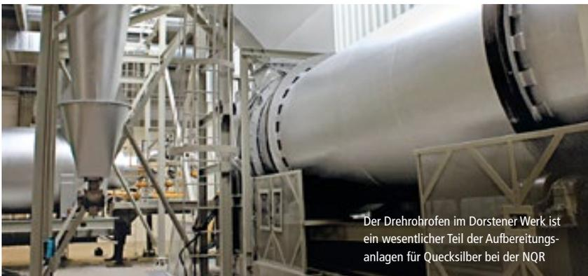
Der Drehrohrföfen im Dorstener Werk ist ein wesentlicher Teil der Aufbereitungsanlagen für Quecksilber bei der NQR
